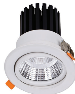
VERSION 15W dimension :Dia110*H110m Diamètre découpe : 100mm
